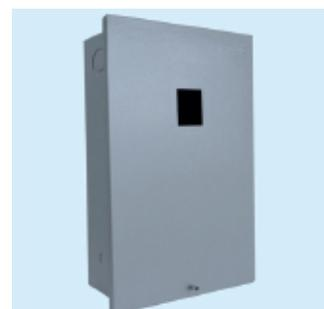
**CAJA EM-1281 NORMA CHILECTRA****Código:** YBBD-0015**Dimensiones app.:** 550x550x250mm. (Alto-ancho-fondo)**Material:** Acero laminado en frío SAE-1010.**Pintura:** Poliéster electroestática en polvo, de color Beige RAL-7032.**Descripción:** Puerta abatible, perno en tubo porta candado. Placa de montaje al fondo de la caja. Perforaciones laterales para pasada de conductores. Taza para perforaciones laterales anti-lluvia. Ferretería apernada a la parte posterior.
